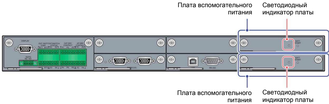
Рисунок 4-17: расположение плат вспомогательного питания и их светодиодных индикаторов
