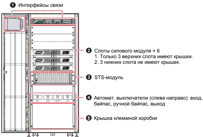
Рисунок 2-4: Шкафы ИБП внутри, передняя дверца открыта
